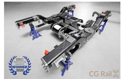
Drehgestellrahmen in CFK-Leichtbauweise: Masseersparnis in Höhe von 50 %
